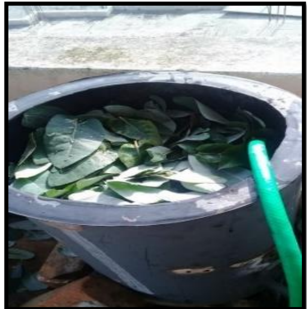
Foto 4. Destilador green forest lleno de hojas de eucalipto.
