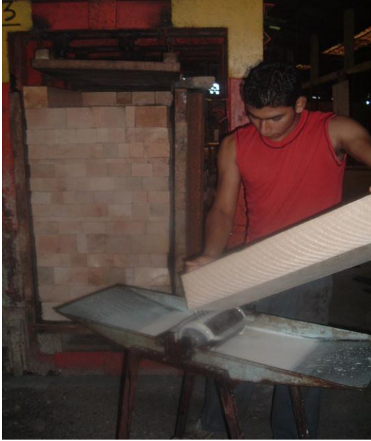
Figura 14 y 15: Encolado de piezas de madera que conforman el bloque.
