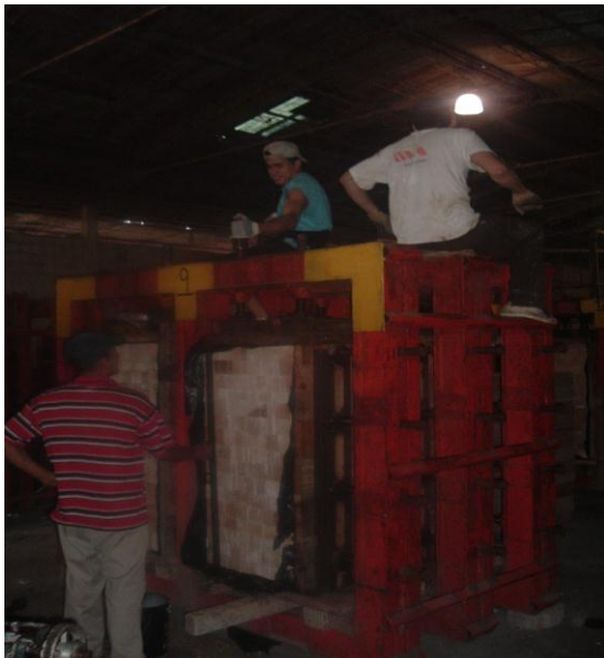
Figura 2: prensa con bloque encolado y apretado manual.
