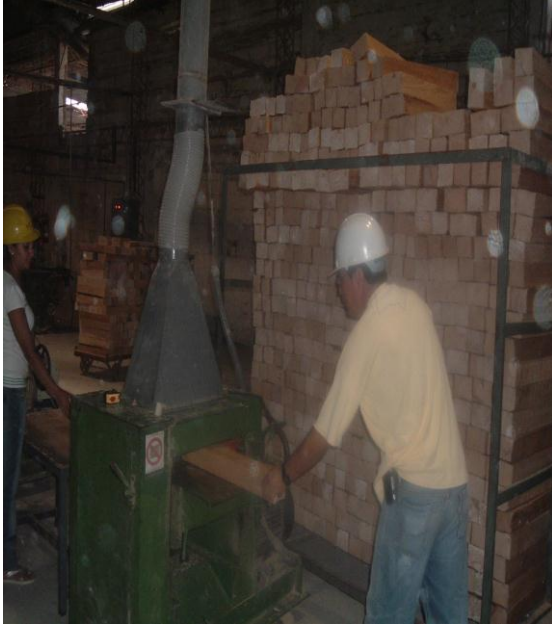
Figura 6 y 7: Madera despuntada para proceso de cepillado.
