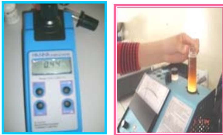
Fotografías 25: Medición de turbidez de jugo de caña Clarificado. UTN. FICAYA. 2006.
