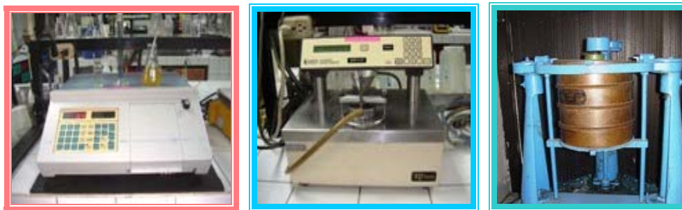
Fotografías 35: Espectrofotómetro, refractómetro y tamices para medir Granulometría. IANCEM. 2007.
