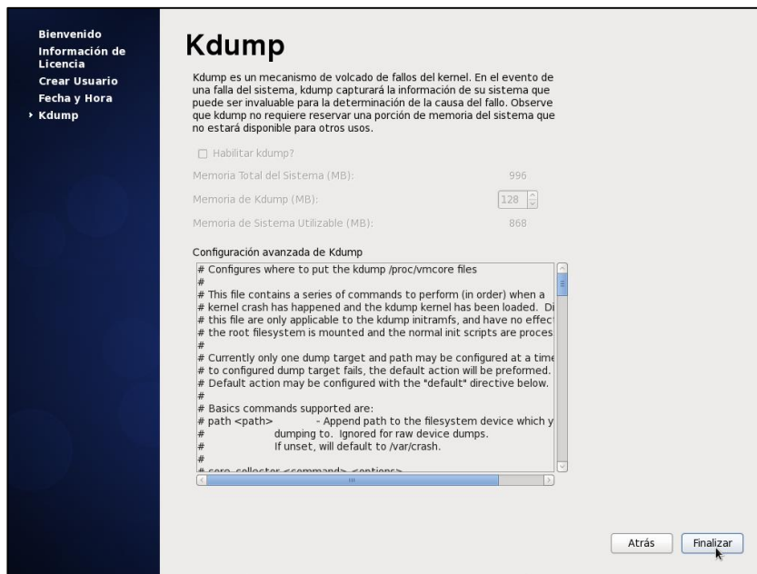
IMAGEN 129.- Mecanismo de Volcamiento del kernel, Fin de la Instalación Fuente: Instalación del Sistema Operativo Centos.
