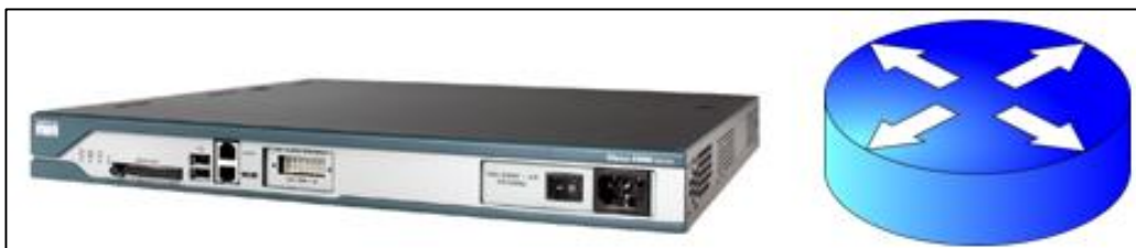
IMAGEN 6.- Router y su Representación en simulación
