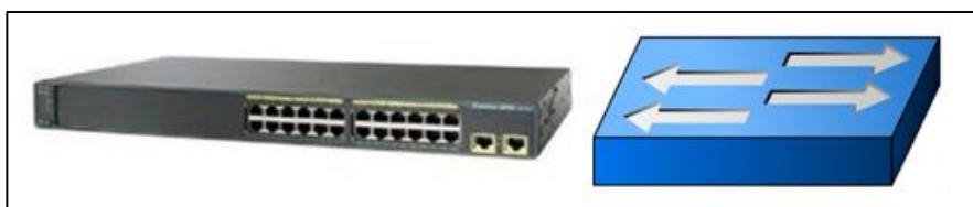
IMAGEN 4.- Switch y su Representación en simulación
